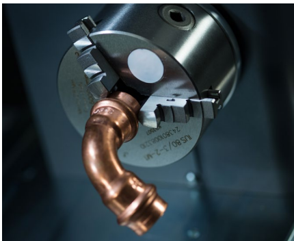
Accesorio rotativo para marcado de piezas cilíndricas
